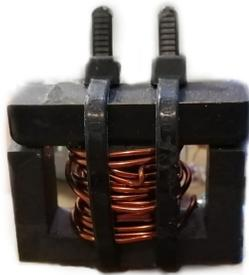
Fig. 15: Inductor construido para el filtro de salida
