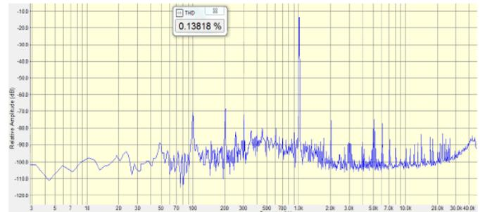
Fig. 29: THD a 1W para una carga de 8Ω.
