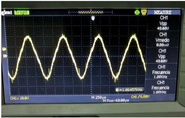
Fig. 24: Salida de casi máxima potencia (39W) de 1kHz a lazo abierto;  $V_{in} = 1,7V_p$
