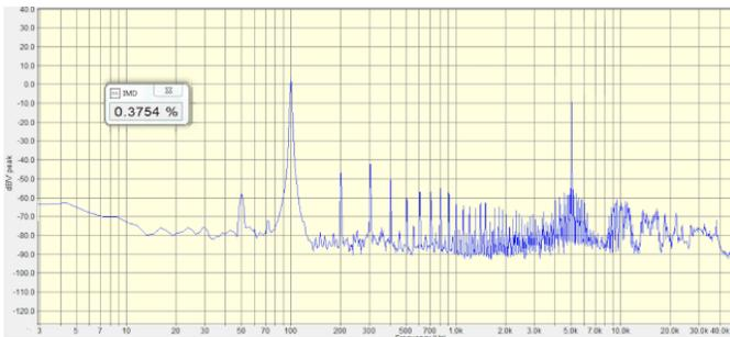
Fig. 32: Intermodulación a 46W para una carga de 8Ω.
