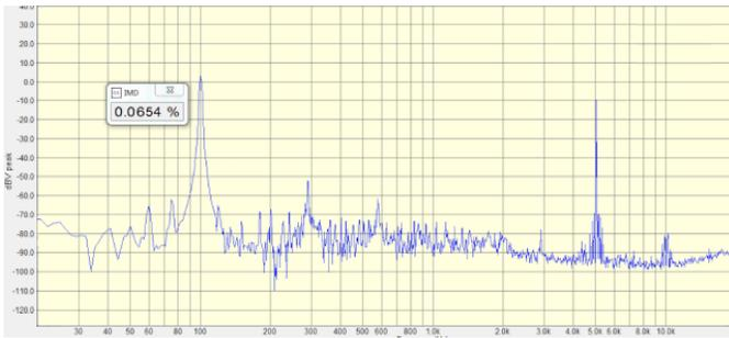
Fig. 31: Intermodulación a 1W para una carga de 8Ω.
