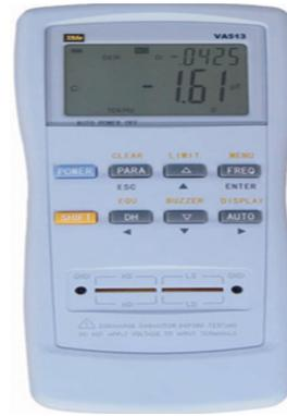
Fig. 45: LCR meter V&A VA511.
