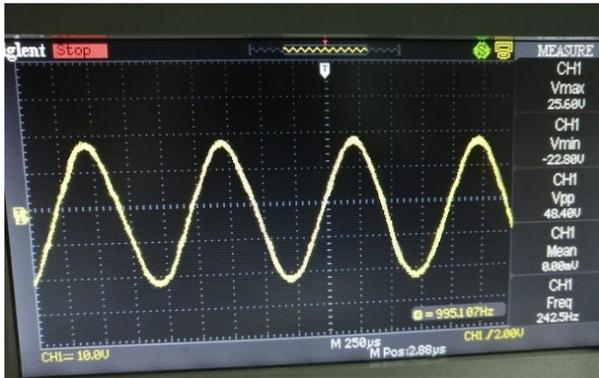
Fig. 25: Salida de casi máxima potencia (36W) de 1kHz a lazo cerrado;  $V_{in} = 2,5V_p$
